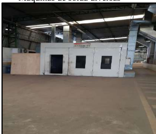
Cabine de pintura
