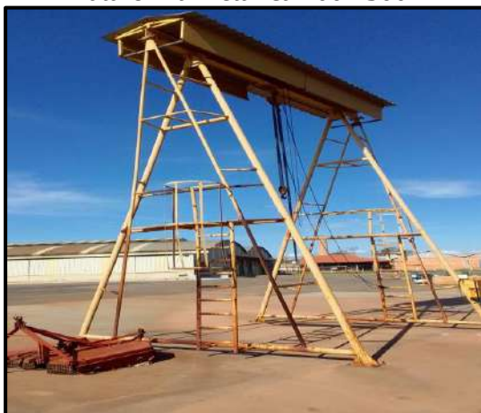
Pórtico com talha
