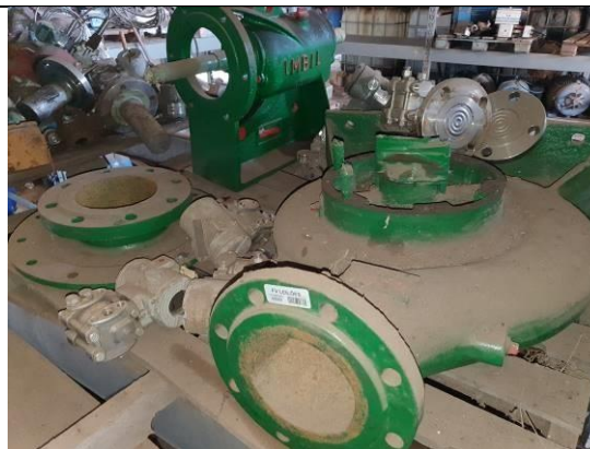
Item 20: Bomba desmontada, desacoplada, sem motor.
