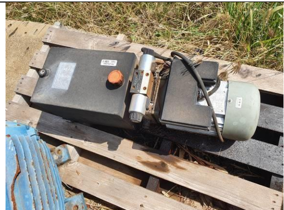
Item 9: Unidade hidráulica com motor, marca Weg.
