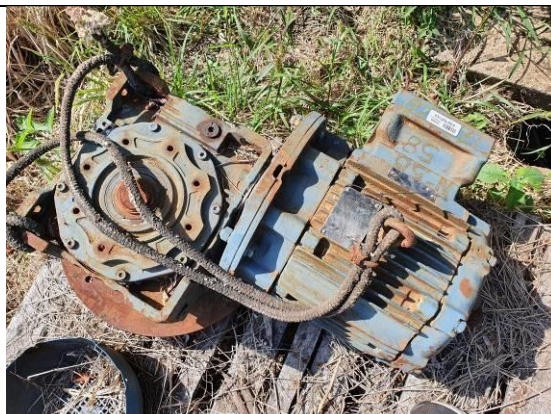
Item 14: Motor elétrico, trifásico, 7,5 cv, marca Weg com redutor.
