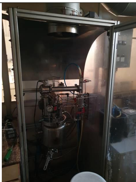
Item 23: Conjunto de Reator piloto de alta pressão, sem marca.
