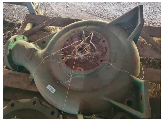
Item 37: Bomba desmontada, desacoplada, sem motor.
