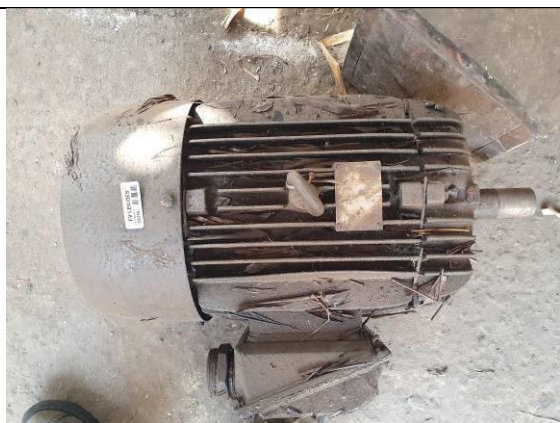
Item 20: Motor elétrico trifásico, marca weg, 2cv.
