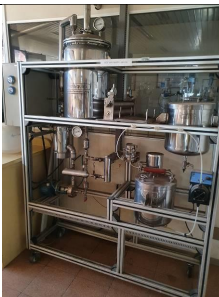
Item 16: Conjunto de Reator piloto de alta pressão, marca Metalquim.
